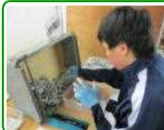
製造会社で部品のバリ取り(トリミング)作業をしました。根気よく同じことを正確に繰り返します。慣れてきたときには、能率も意識していきます。
